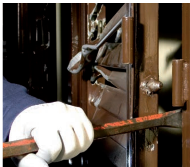
LATO CERNIERA APERTA DOPO SOLI 2 MINUTI Il perno della cerniera si spezza e il rostro parastrappo esce dal telaio
