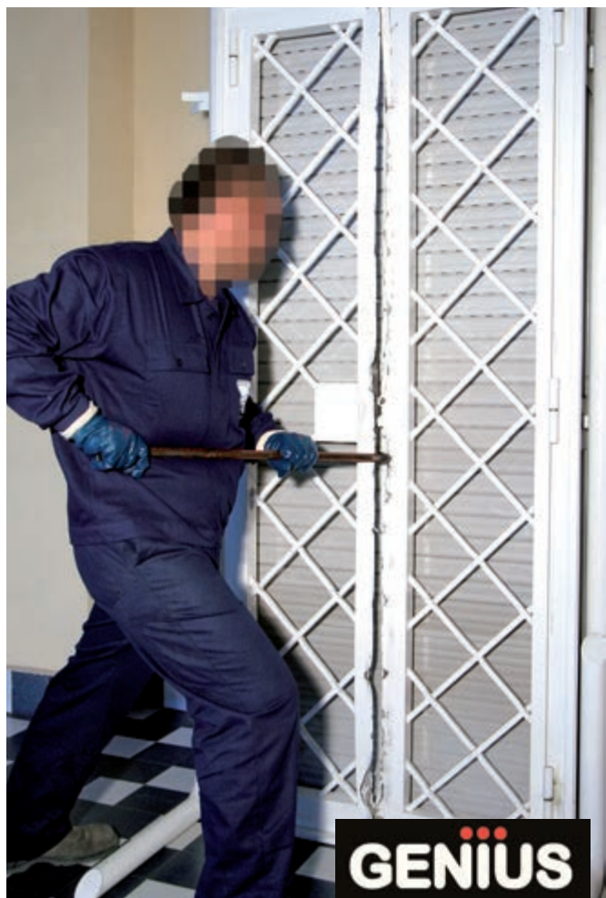
ANCORA CHIUSA DOPO 25 MINUTI DI SCASSO Il chiavistello della serratura è ancora nel telaio fisso, l'anta è chiusa
