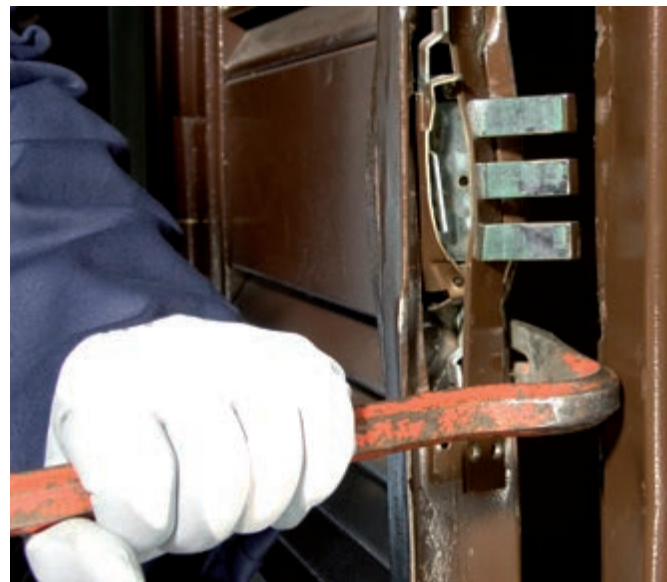
LATO SERRATURA APERTA DOPO SOLO 1 MINUTO Il chiavistello esce dal telaio fisso
